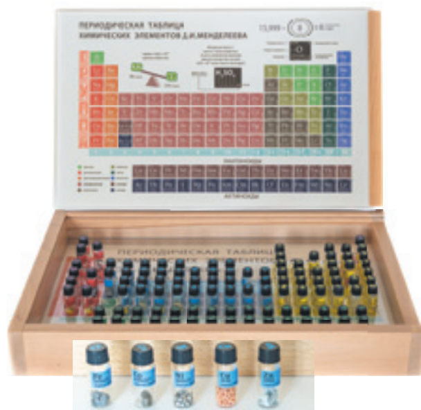
В деревянном ящике: 118 ампул с обозначением химических элементов, ложемент из оргстекла на 118 отверстий диам. 17 мм.
